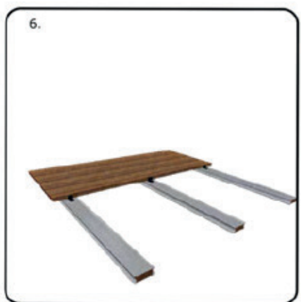
6. Diele (inkl. SenoFix Verbinder) an Diele legen. Der Verbinder gibt den Fugenabstand von 7 mm vor.
